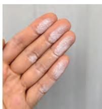
経年により外壁塗装・屋根塗装が劣化し、塗装の色が変わり表面の顔料が粉状になって浮き出てきます。塗り替え時期の症状です。
