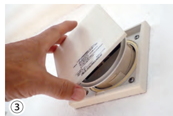
③ 左へ45度回して本体を引き抜きます。
